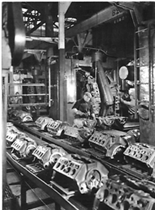
A Star is born: V8 Flathead auf dem Fließband.
