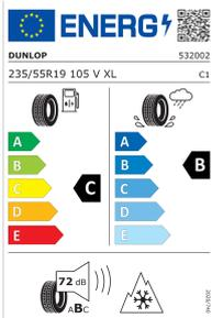
Kraftstoffeffizienz: C, Nasshaftung: B, Abrollgeräusch: B, dB: 72
