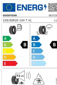
Kraftstoffeffizienz: B, Nasshaftung: B, Abrollgeräusch: B, dB: 72
