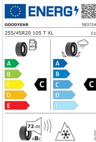
Kraftstoffeffizienz: C, Nasshaftung: C, Abrollgeräusch: B, dB: 72
